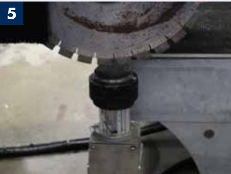
EN Tool sensing device in tool magazine FR Palpeur d'outils intégré au magasin DE Messeinheit integriert in das Magazin ES Palpador medida de herramienta
