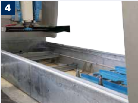
EN Tool magazine for 2 discs and 9 milling cutters FR Magasin d'outils pour 2 disques et 9 fraises DE Werkzeugmagazin für 2 Scheiben und 9 Fräser ES Almacen de herramienta para 2 discos y 9 fresas
