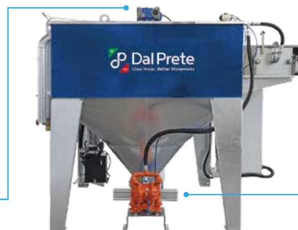
Système automatique d'évacuation des boues et alimentation du filtre-pressé.
