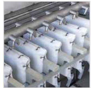
Détail d'un lavage automatique : buses de nébulisation d'eau clarifiée pour le nettoyage des toiles du filtre-pressé.
