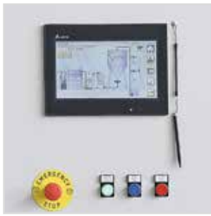
Écran de commande tactile de 10" pour la gestion de toutes les opérations du système.
