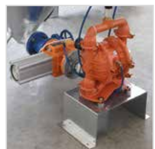
Système automatique d'évacuation des boues et alimentation du filtre-pressé.
