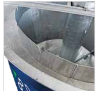
Déversoir d'évacuation de l'eau clarifiée sur la partie supérieure du cylindre.
