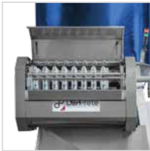
Filtre-pressé galvanisé à chaud avec couvercle en acier inox et caniveau d'évacuation.
