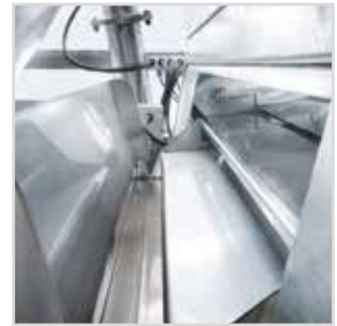
Système de récupération de l'eau du filtre-presse avec bacs d'égouttement automatiques.
