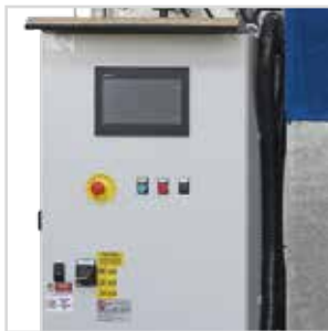
Écran commande tactile de 10" pour la gestion de toutes les opérations du système.
