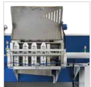
Filtre-pressé galvanisé à chaud avec couvercle en acier inox et caniveau d'évacuation.
