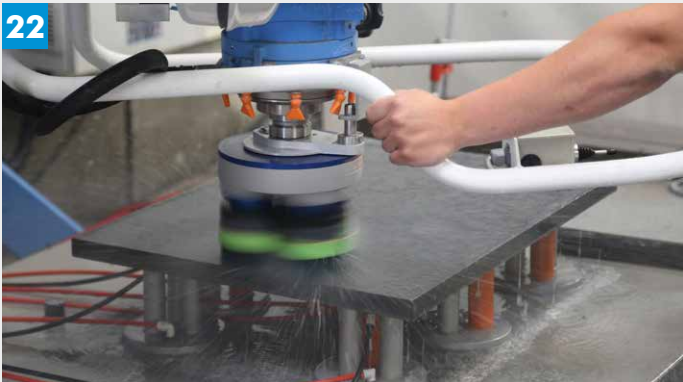
EN Granite flat polishing with satellite head AR-3 FR Polissage à plat granit avec tête de polissagetype « satellite » AR-3 DE Granit schleifen mit Planetenschleifkopf AR-3 ES Pulido de granito con cabeza del satélite AR-3
