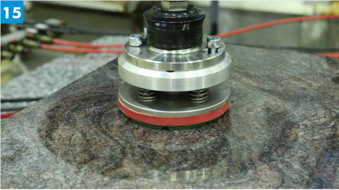
EN Achievement of concave drainboards FR Réalisation d'égouttoirs concaves DE Herstellung einer Parabolabtropffläche ES Realización de escurrerplatos concavos
