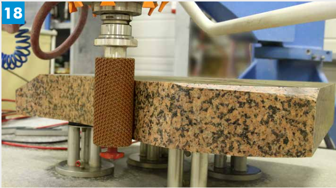
EN Thick granite curved edge polishing FR Polissage chants épais courbes DE Polieren gewölbter Massivkanten in Granit ES Pulido de cantos curvos gruesos
