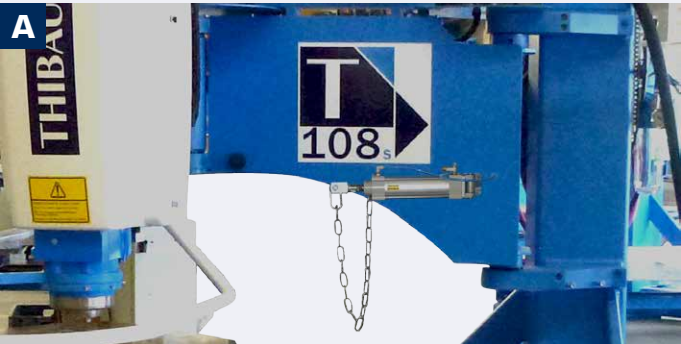
EN Pneumatic cylinder for side pressure FR Vérin pneumatique de pression latérale DE Pneumatikzylinder für seitlichen Druck ES Gato neumático de presión lateral
