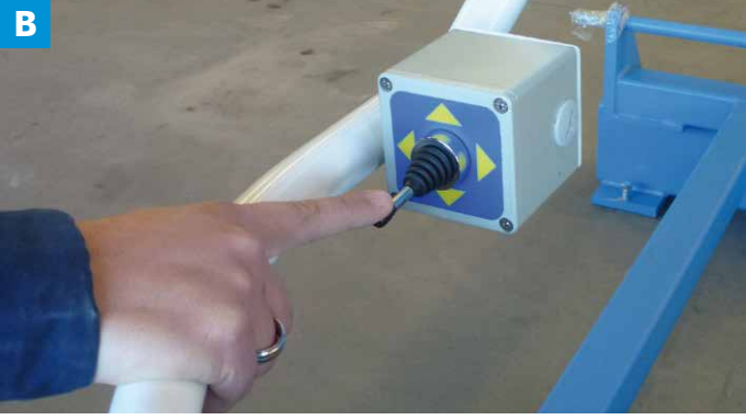
EN Up & down feed control FR Descente impulsionnelle DE Impulsabsenkung ES Bajada con impulsión
