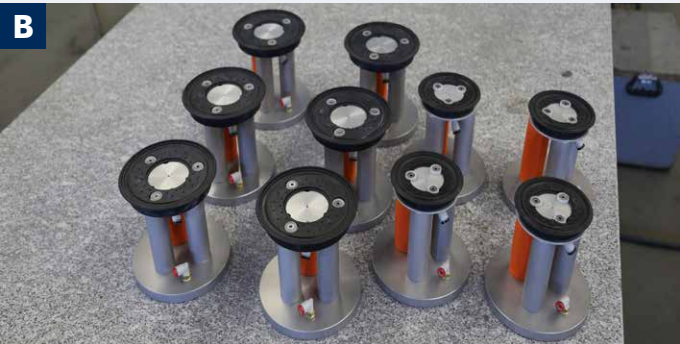
EN Clamping by suction cups over the entire table surface FR Bridage par ventouses sur toute la surface de la table DE Befestigung mit Saugnapfen auf der gesamten Tischfläche ES Bridaje por ventosa sobre toda la superficie de la mesa
