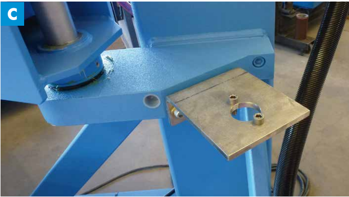
EN Support for quick tool changing FR Support pour changement rapide des outils DE Einheit für schnellen Werkzeugwechsel ES Soporte para cambio rápido de herramientas
