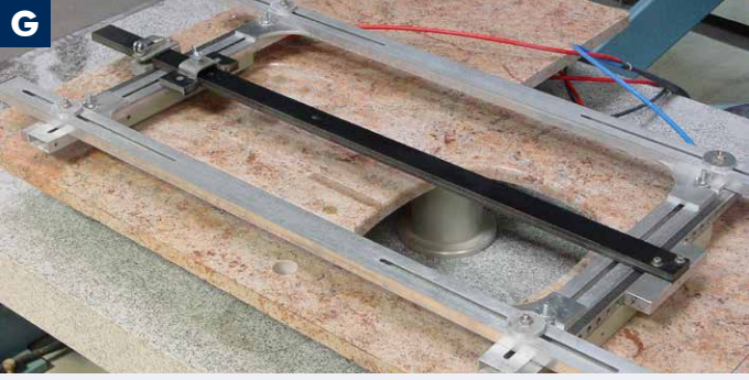
EN Universal and grooving template FR Gabarit universel et de rainurage DE Vakuum-Versorgungsrampe ES Plantilla universal y de ranurado
