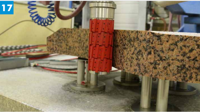
EN Thick curved edges milling FR Fraisage de chant courbe (forte épaisseur) DE Fräsen gewölbter Massivkanten ES Fresado de cantos curvos (espesores gruesos)
