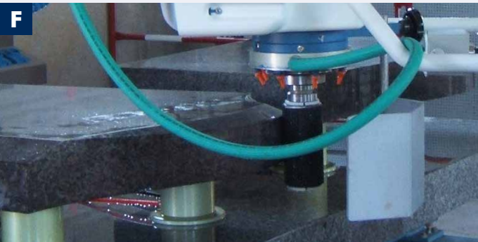
EN Protection housing for monument tools FR Carter de protection outils funéraire DE Schutzhaube für Grabmalwerkzeuge ES Carter de proteccion para herramientas funerarias
