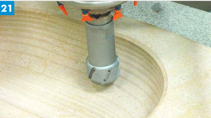
EN Milling inside wash basin in limestone FR Moulurage évier dans la masse en pierre calcaire DE Fräsen eines Waschbeckenausschnittes aus Sandstein ES Fresado de fregadero macizo en piedra caliza
