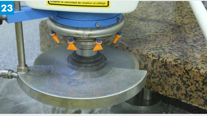
EN Horizontal sawing (piece tilting) FR Sciage horizontal (inclinaison de la pièce) DE Horizontalsägen ES Corte horizontal (inclinación de la pieza)
