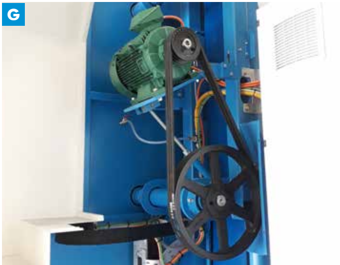
EN Cable drive motor with variable speed: • 11 kW: suitable for sawing granite and hard materials • 15 kW: ideal for sawing limestone and soft materials FR Moteur d'entraînement du câble avec vitesse variable : • 11 kW : adapté au sciage du granit et des matériaux durs • 15 kW : idéal pour le sciage du calcaire et des matériaux tendres DE Seilantriebsmotor mit variabler Drehzahl: • 11 kW: geeignet zum Sägen von Granit und harten Materialien • 15 kW: ideal zum Sägen von Kalkstein und weichen Materialien ES Motor de accionamiento del cable con velocidad variable: • 11 kW: adecuado para el corte de granito y materiales duros. • 15 kW: ideal para el corte de piedra caliza y materiales blandos.
