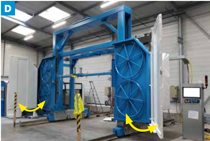
EN Hinged side covers for easy access to the diamond wire. FR Carters latéraux sur charnières pour un accès au câble diamanté facilité. DE Seitliche Klappen auf Scharnieren für einen erleichterten Zugang zum Diamantdraht. ES Cubiertas laterales con bisagras para facilitar el acceso al cable de diamante.
