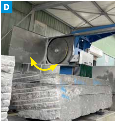
EN Hinged side covers for easy access to the diamond wire. FR Carters latéraux sur charnières pour un accès au câble diamanté facilité. DE Seitliche Klappen auf Scharnieren für einen erleichterten Zugang zum Diamantdraht. ES Cubiertas laterales con bisagras para facilitar el acceso al cable de diamante.
