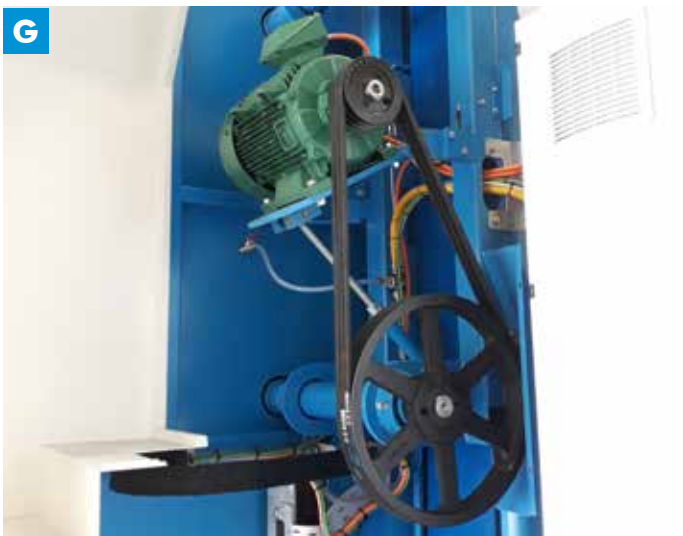
EN 2 identical cable drive motors with variable speed, choice of: • 11 kW: suitable for cutting granite and hard materials • 15 kW: ideal for cutting limestone and soft materials FR 2 moteurs d'entraînement du câble (identiques) avec vitesse variable, au choix : • 11 kW : adapté au sciage du granit et des matériaux durs • 15 kW : idéal pour le sciage du calcaire et des matériaux tendres DE 2 identische Kabelantriebsmotoren mit variabler Geschwindigkeit, wahlweise: • 11 kW: geeignet zum Schneiden von Granit und harten Materialien • 15 kW: ideal zum Schneiden von Kalkstein und weichen Materialien ES 2 motores de accionamiento por cable idénticos con velocidad variable, a elegir: • 11 kW: adecuado para cortar granito y materiales duros • 15 kW: ideal para cortar piedra caliza y materiales blandos
