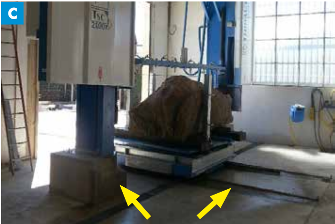
EN Fixed machine with non-motorized mobile tables on rails. FR Machine fixe avec tables mobiles non motorisées sur rails. DE Feste Maschine mit nicht motorisierten, beweglichen Tischen auf Schienen. ES Máquina fija con mesas móviles no motorizadas sobre rieles.
