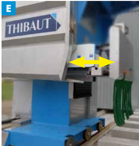
EN X-axis with protective shield reducing strain on the diamond wire and facilitating cooling as well as wedge insertion. FR Axe X avec bouclier de protection réduisant l'effort sur le câble diamanté et facilitant l'arrosage ainsi que l'insertion des cales. DE X-Achse mit Schutzschild, das die Belastung des Diamantseils reduziert und sowohl die Kühlung als auch das Einsetzen der Keile erleichtert. ES Eje X con escudo de protección que reduce el esfuerzo sobre el cable diamantado y facilita tanto el riego como la inserción de las cuñas.
