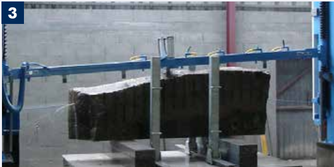
EN Anti-jamming cable bar with spray ramp for deformed blocks. FR Barre anti coincement de cable avec rampe d'arrosage pour blocs difformes. DE Anti-Kabelklemmleiste mit Bewässerungsrampe für unförmige Blöcke. ES Barra de cable antiatasco con rampa de pulverización para bloques deformados.
