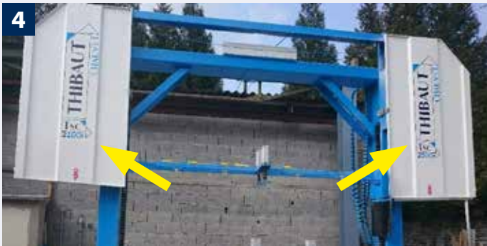
EN Stainless steel machine casings. FR Carters machine en inox. DE Maschinengehäuse aus Edelstahl. ES Carcasas de máquinas de acero inoxidable.
