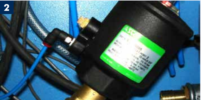
EN Solenoid valve on clean water supply. FR Electrovanne sur alimentation d'eau propre. DE Magnetventil auf Frischwasserzufuhr. ES Electroválvula en el suministro de agua limpia.
