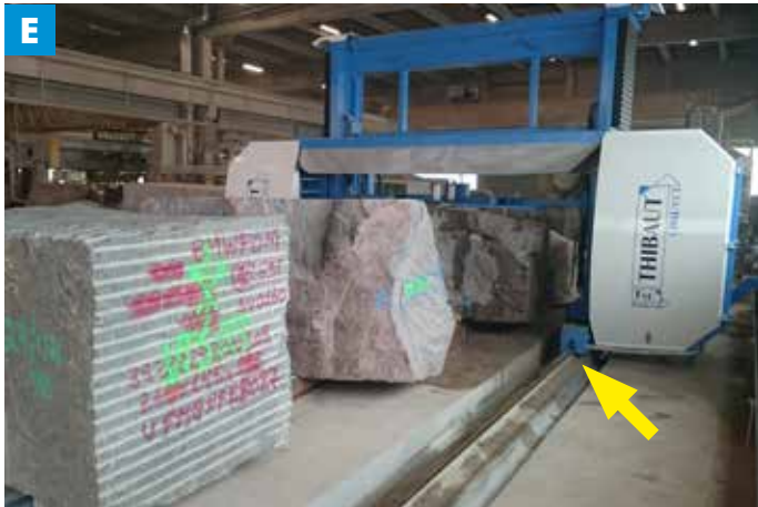
EN TSC2100 M = Mobile machine on running track. FR TSC2100 M = Machine mobile sur chemin de roulement. DE TSC2100 M = Mobile Maschine auf Fahrweg. ES TSC2100 M = Máquina móvil sobre vía de rodadura.
