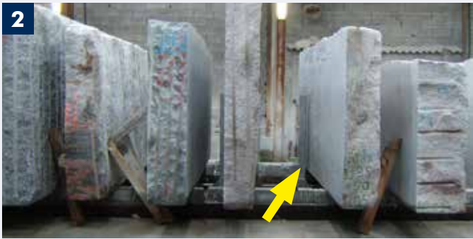
EN Additional stanchion post for runway. FR Rancher supplémentaire pour rail au sol. DE Zusätzliche Strebe für Bodenführungsschiene. ES Puntal adicional para camino de rodadura.
