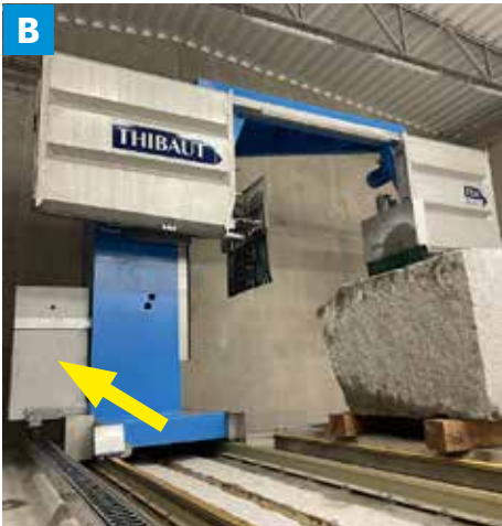
EN Granite counterweight FR Contre-poids en granit DE Gegengewicht aus Granit ES Contrapeso de granito
