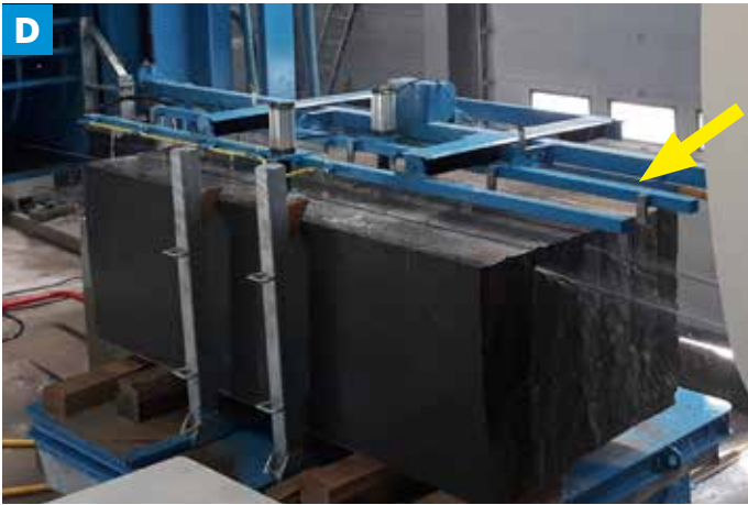
EN Anti-jamming cable bar with spray ramp for deformed blocks. FR Barre anti coincement de cable avec rampe d'arrosage pour blocs difformes. DE Anti-Kabelklemmleiste mit Bewässerungsrampe für unförmige Blöcke. ES Barra de cable antiatasco con rampa de pulverización para bloques deformados.
