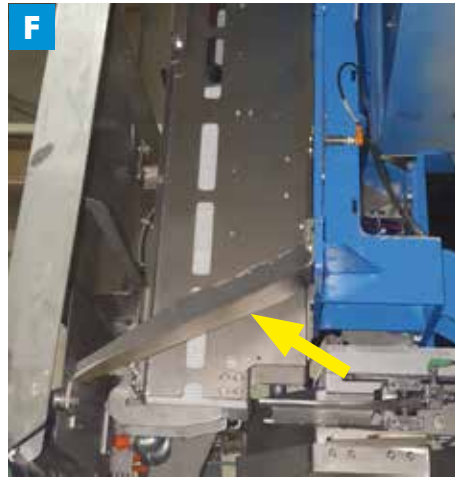
EN The machine comes with two 150-piece wedge magazines, featuring automatic insertion by a robotic arm. FR La machine est équipée de 2 magasins de cales d'une capacité de 150 unités chacun, avec insertion automatique par bras robotisé. DE Die Maschine ist mit zwei Keilmagazinen mit je 150 Stück ausgestattet und verfügt über eine automatische Bestückung durch einen Roboterarm. ES La máquina está equipada con dos almacenes de cuñas de 150 unidades, con inserción automática mediante un brazo robotizado.
