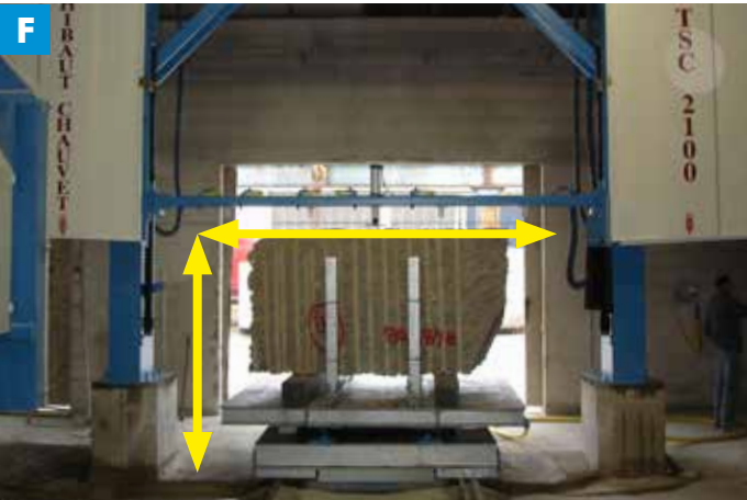
EN Sawing capacities available: • width 3800 mm, height 2100 mm • width 4500 mm, height 2792 mm FR Capacités de sciage au choix : • largeur 3800 mm, hauteur 2100 mm • largeur 4500 mm, hauteur 2792 mm DE Sägeeinstellungen nach Wahl: • Breite 3800 mm, Höhe 2100 mm • Breite 4500 mm, Höhe 2792 mm ES Capacidades de corte a elegir: • anchura 3800 mm, altura 2100 mm • anchura 4500 mm, altura 2792 mm
