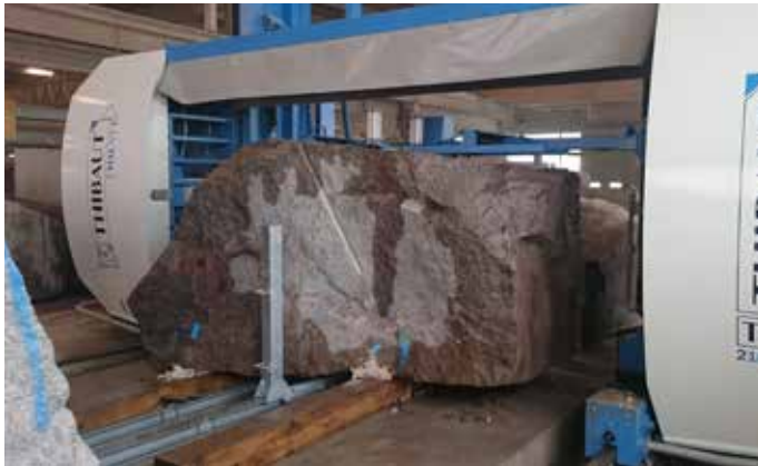
EN Galvanized rails equipped with stanchion for block support. FR Rails galvanisés équipés de ranchers pour support des blocs. DE Verzinkte Schienen mit Stützen zur Aufnahme von Blöcken. ES Rieles galvanizados equipados con refuerzos para soporte de bloques.
