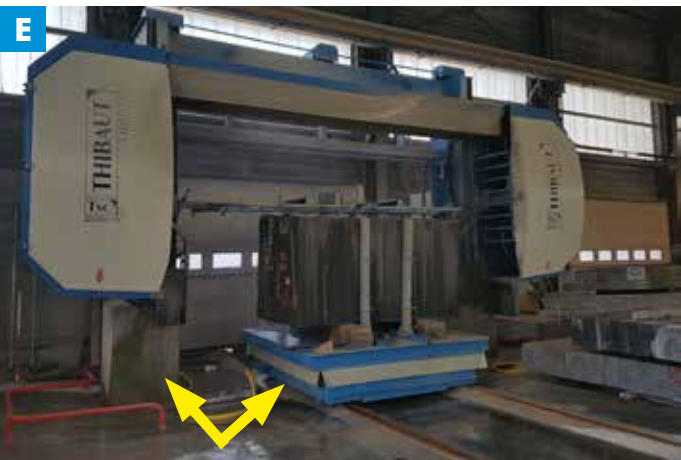
EN TSC2100-2C F = Fixed machine with movable tables. FR TSC2100-2C F = Machine fixe avec tables mobiles. DE TSC2100-2C F = Feste Maschine mit beweglichen Tischen. ES TSC2100-2C F = Máquina fija con mesas móviles.
